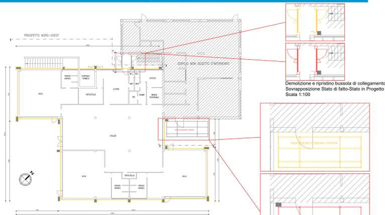
Demolizione e ripristino bussola di collegamento Sovrapposizione Stato di fatto-Stato in Progetto Scala 1:100
