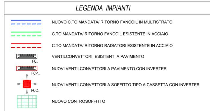
VENTILCONVETTORE A PAVIMENTO FCP
