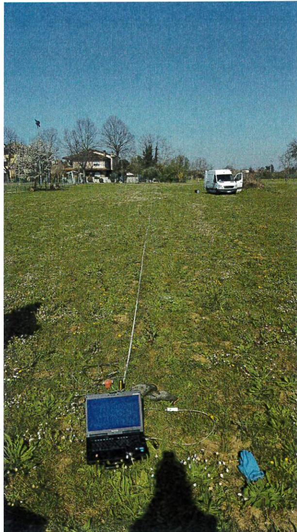
Dalla prova MASW si vede l'orizzonte relativo alla velocità delle onde S nel terreno.
